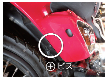
固定されている2箇所を取り外し、内側の爪を折らないように注意しながらゆっくりと取り外します。(外れた瞬間にキックペダルやステップに当たって傷つかないように、ウェスなどで養生しておく事をおすすめします。)
