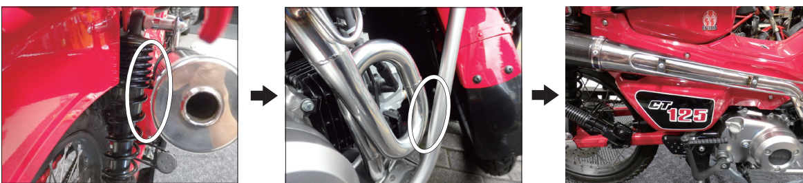
転倒歴のある車輛などは特に各部の隙間をよく確認して下さい。
