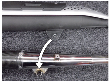
純正マフラーに付いていたゴムダンパーとツバ付きカラーをピュアスポーツマフラーに移し替えます。
