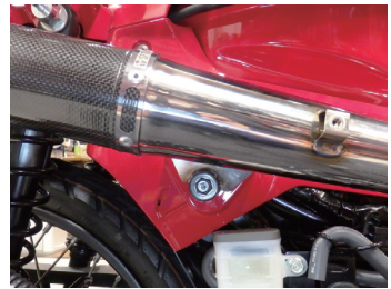
サイレンサー下部を仮止めします。固定には純正マフラーに使用していたボルト / ワッシャーを再使用します。
