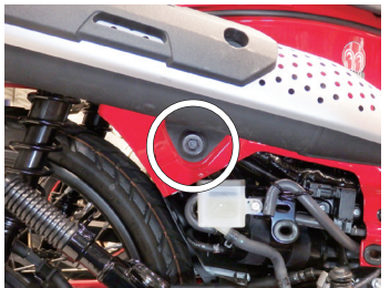
サイレンサー上部を固定しているナットを取り外し、マフラー一式を車体から取り外します。(傷つき防止の為にフレーム周りは養生しておきましょう。)
