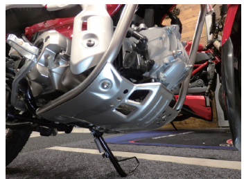
アンダーカバーを取り外します。(フレームに4点止めされています。)
