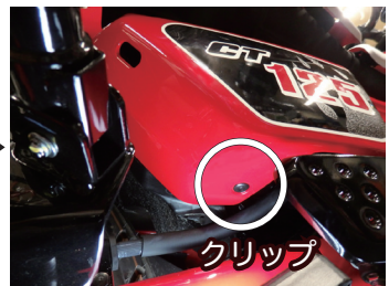
固定されている2箇所を取り外し、内側の爪を折らないように注意しながらゆっくりと取り外します。(外れた瞬間にキックペダルやステップに当たって傷つかないように、ウェスなどで養生しておく事をおすすめします。)
