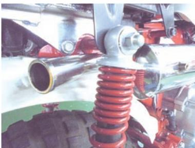
7. 調整した位置がずれないように注意しながら、先にエキゾーストパイプフランジ部のジョイントナットを、均等に規定トルクまで締め付けます。
