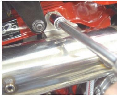
9. サイレンサー前方のジョイント部のバンド (33-35mm) を規定トルクまで締め付けます。
