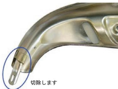
切除した場合、切断面の錆止めの為、耐熱ペイントでタッチアップをされる事をお勧めします。
