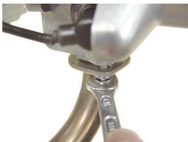
8. サイレンサー ASSY. ステーパー部のノーマルの六角ボルトを規定トルクまで締め付けます。
