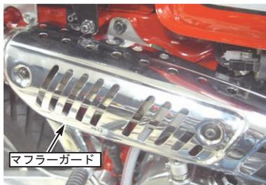
12. エキゾーストパイプに取り外しと逆手順に、エキゾーストパイプカバーを取り付けます。
