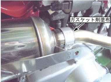
5. エキゾーストパイプフランジを、シリンダーヘッドのスタッドボルトに通し、ノーマルマフラーを固定していたジョイントナットを用いて固定し、仮止めします。
