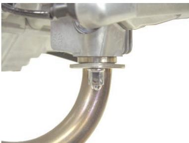
6. サイレンサーのエキゾーストパイプと、車両のリアフェンダーとのクリアランスを確認し、干渉が無い位置に、サイレンサー本体とエキゾーストパイプの位置を調整します。
