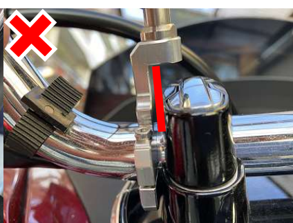
✕取付部隙間あり (C-27)
