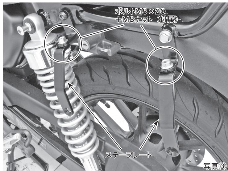
4. 前項③で仮止めしたステープレートに、付属のテーパーボルトM8×20とナットを使用し、サイドバックサポートを仮止めし、位置やクリアランスなどを確認、調整をしながら、すべてのボルト、ナットを規定トルクで締め付けて完成です。(写真④、⑤)
