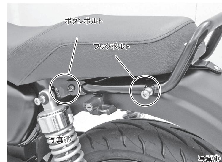
2. 前項①で取り外したボタンボルトの場所に、フロントサブステーを取り外した純正ボタンボルトでフックボルトの場所にリアサブステーを付属のボルトM8×15を使用し、それぞれ仮止めします。(写真②)
