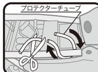
1 フレームにプロテクターチューブを巻き付けて長さを調節し、余った部分はカットします。
