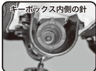
**注意** ⚠ 使用済カートリッジポンペを取外した際、キーボックス内側の針に損傷が無いか確認してください。針に損傷がある場合は、取扱店にご相談ください。針が損傷した場合、エアバッグは作動しません。
