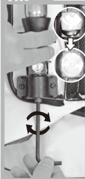
3.六角レンチでキーボールの穴が中心にくるよう調節します(写真4)
