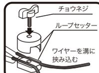
3 プロテクターチューブから出たワイヤーをループセッターで仮止めし、伸縮ワイヤーの長さを調節します。
